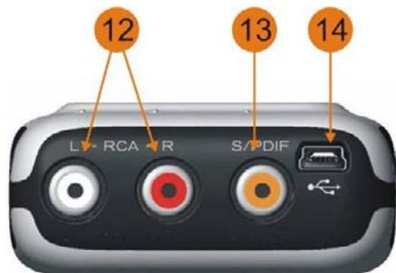
12. RCA出力端子 (RCA) : RCA端子を装備したオーディオ機器でMicroTrack 24/96をモニタリングする場合にオーディオ機器を接続します。
